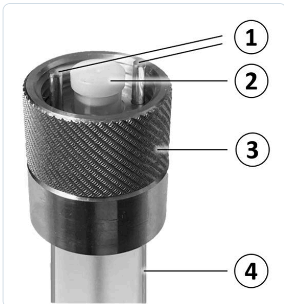
Figure 5-1 Dispositif d'échantillonnage manuel 1 : Goupilles de positionnement, 2 : Fiche, 3 : Bague de fixation, 4 : Tube à bouchon fileté de 5 mL.
